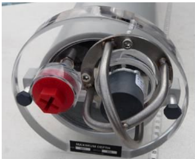
Photo 2. Vue à l'intérieur du cylindre étanche, extrémité et micro extérieur et dispositif mis en place.
