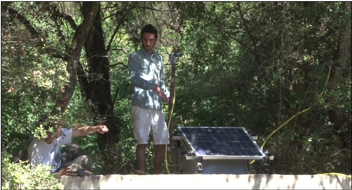
Figure 10 : Installation de la JASONbox du barrage de la Solitude. Ici Hervé Glotin (à gauche) explique à Charles Le Bozec (à droite) l'importance de l'orientation des microphones afin de pouvoir par la suite trajectographier les chiroptères du barrage.
