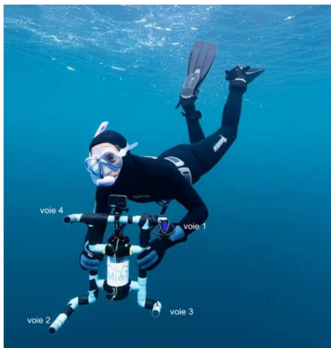
Figure 6.5 : Antenne acoustique de 2021 avec ses 4 hydrophones et sa GoPro (crédit photo Granzotto)
