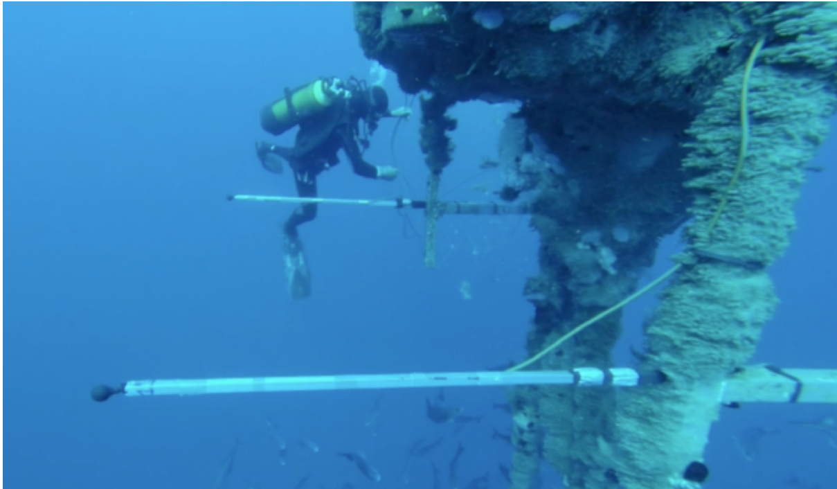
Figure 2.2 : La bouée BOMBYX en 2016 avec ses deux hydrophones HN1 pointant vers le sud, la voie 0 est au premier plan (Est), la voie 1 au fond (Ouest).
