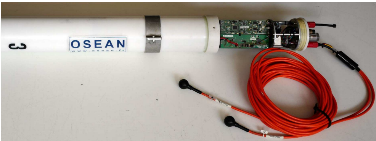
Figure 1.2 : le tube d'enregistrement de Bombyx, avec sa carte son OSEAN, et ses deux hydrophones Neptune HN1
