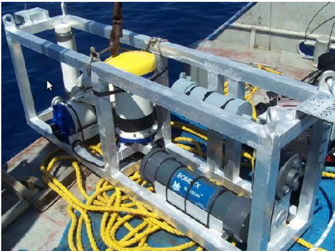
Figure 1.3 : La bouée BOMBYX équipée de son ADCP ce qui a permis une mesure des courants dans la première année et constater que la bouée était stable, calée dans le courant Ligure, avec ses deux hydrophones dirigés vers le Sud dès sa configuration finale en 2016.
