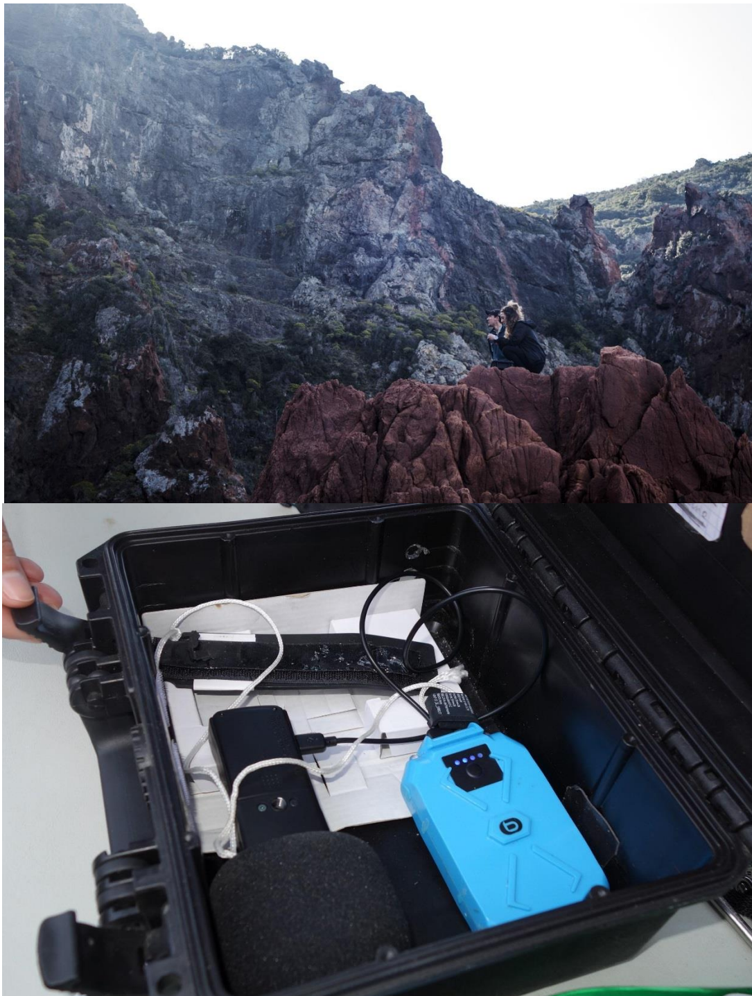
Figure 94 Pose des dispositifs acoustiques terrestres à Elpa Nera et photographie des instruments.
