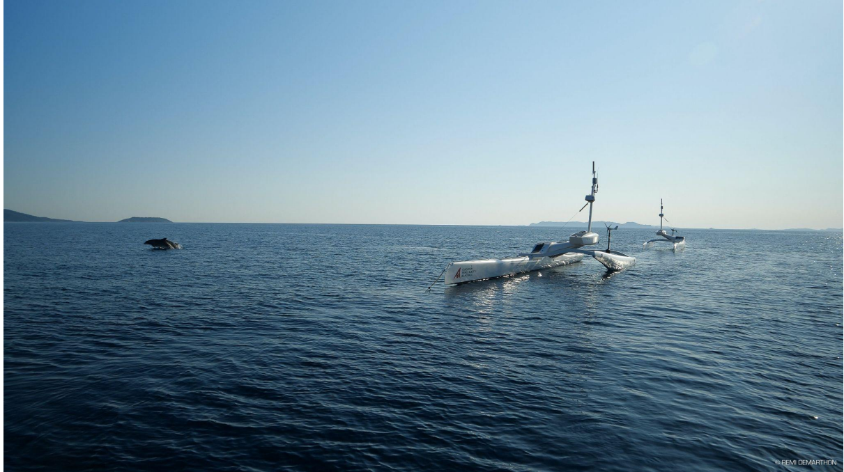
Figure 2 : Les drones Sphyrna équipés d'hydrophones et du système JASON ont écouté la faune proche des côtes durant le confinement COVID 2021, ici Grand dauphin, mais aussi des meutes de cachalots au large http://sabiody.lis-lab.fr/pub/SPHYRNA/PHOTOS/Sphyrna2020_GroupeTursiops_Hyeres_MerSilencieuse_Covidconfinement.jpg (crédit Seaproven).
