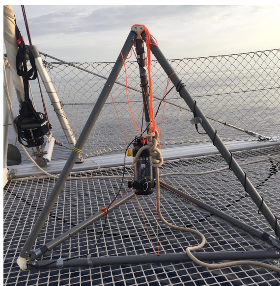
Enregistreur passif Tétra à 4 micros – prototype spécialement mis au point
