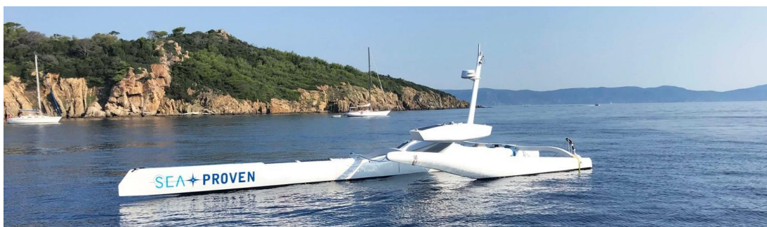
Figure : Photo du SphyrnaALV 55 (Autonomous Laboratory Vessel) développé par l'entreprise « Seaproven »
