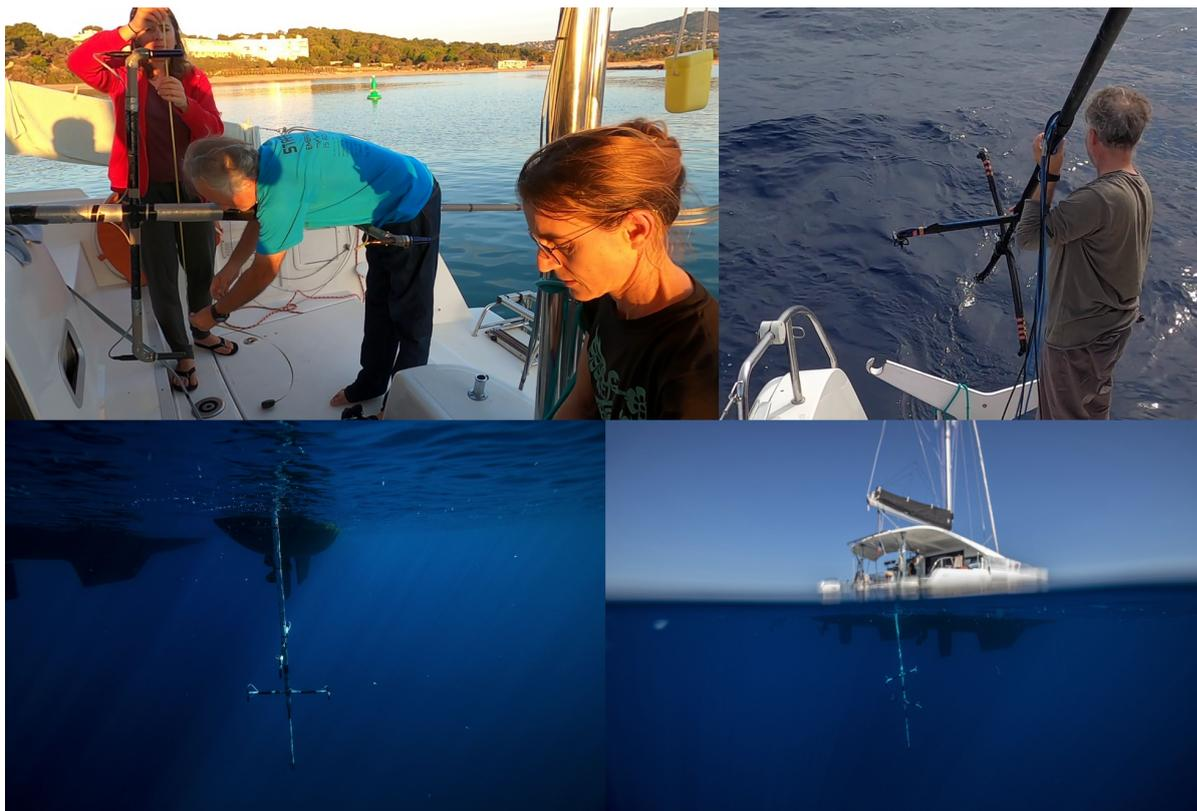
Figure 3.4 : (Haut gauche) Installation de l'antenne Baguera. (Haut droit) Mise à l'eau de l'antenne. (Bas) Vues sous-marines de l'antenne en place (crédit F. Sarano / Longitude 181).
